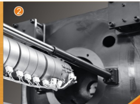
② 中大型机平衡双射移油缸设计 Balanced double-cylinder design
